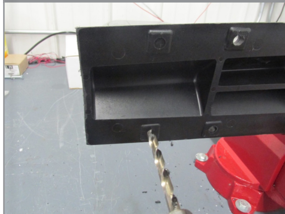
FIGURA 3 - TALADRAR EL SOPORTE DE POLIETILENO DESPUÉS DE RECORTARLO
