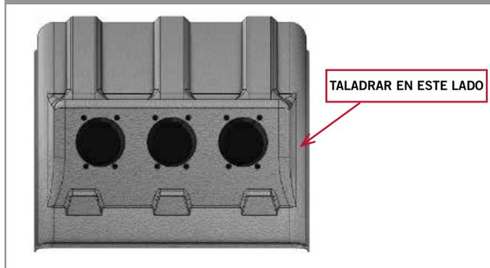
FIGURA 3 - UBICACIÓN DE LOS ORIFICIOS DE CABLEADO
