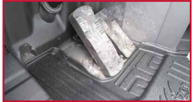
Figura 3 - Contacto del tapete del conductor con el panel de protección.
