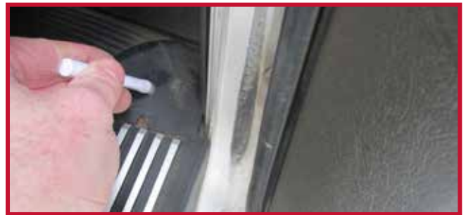
Figure 17 – Crochet de tapis côté passager installé
