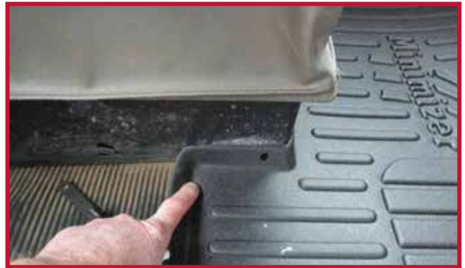
Figure 10 – Emplacement du crochet du tapis côté conducteur
