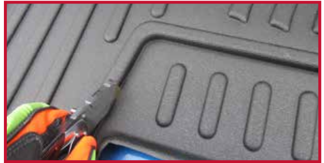
Figure 15 – Découpage du tapis côté passager
