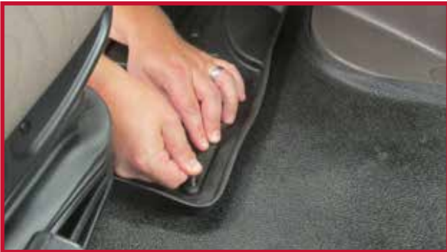
Figure 7 – Appliquer une pression sur le crochet
