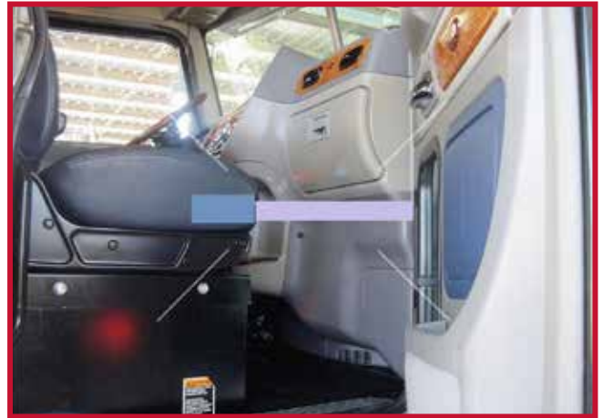
Figura 4 - Asiento del pasajero con almacenamiento de la batería
