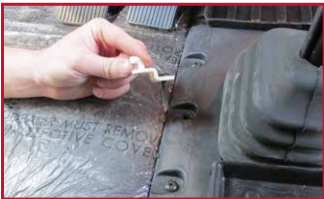
Figura 12 - Instalación del gancho
