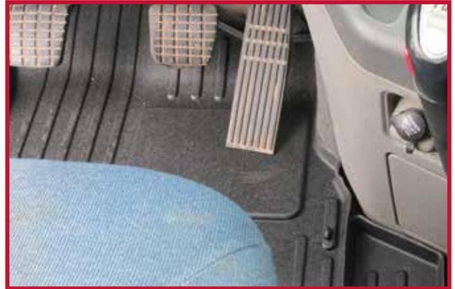
19. Tire del tapete del conductor hacia la parte trasera del camión para confirmar que el gancho está completamente encajado en el tapete y que el gancho está adherido al piso. Si el gancho no funciona correctamente o el tapete no puede instalarse de forma segura, no utilice un tapete Minimizer en el lado del conductor del vehículo.
