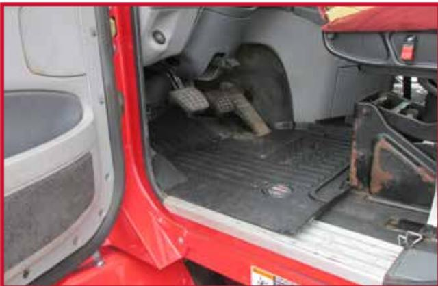
**Nota:** Cuando se instala en camiones equipados con un asiento de conductor EzyRider, el material del tapete detrás del borde elevado tendrá que ser recortado con una navaja como se muestra en la figura 7. El borde elevado está diseñado para actuar como guía de corte y contener el líquido. Los camiones equipados con asientos del mercado de accesorios o cuya posición de asiento ha sido modificada también pueden requerir un recorte manual a lo largo del borde elevado.
