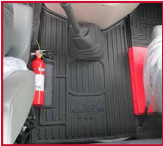
Figura 5 - Instalación del tapete central recortado
