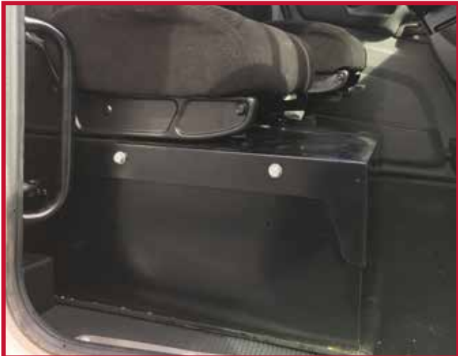
Figure 8 – Base de siège du passager avec caisson de batterie
