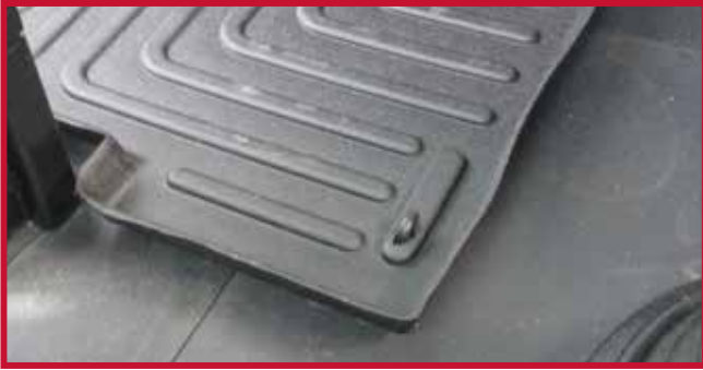
Figure 6 – Confirmer l'emplacement du tapis côté conducteur et crochet
