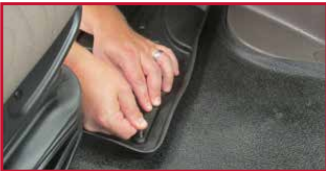
Figure 7 – Appliquer une pression sur le crochet
