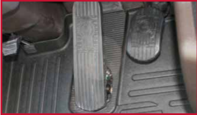
Figura 2 - Pedal de aceleración montado en el piso
