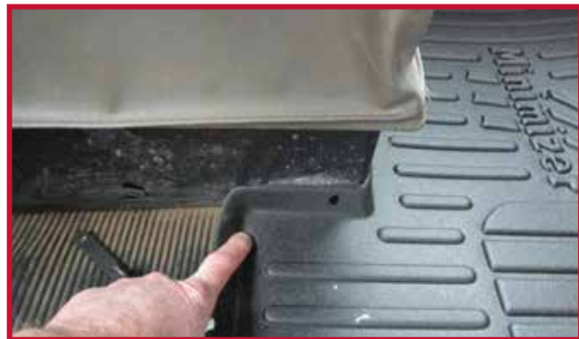
Figura 10 - Ubicación del gancho del tapete del conductor
