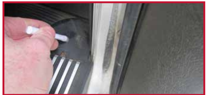
Figura 17 - Gancho del tapete del pasajero instalado
