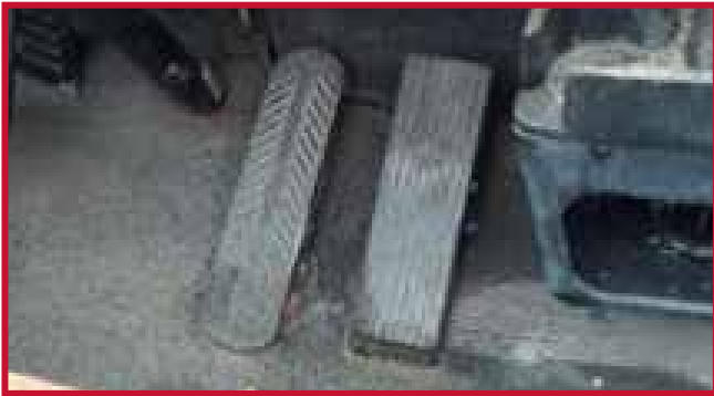
Figura 2 - Pedal de aceleración montado en el piso
