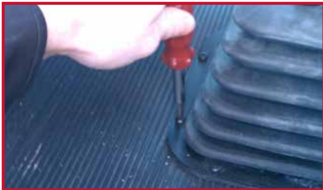
Figura 8 - Retire el tornillo de la bota de la palanca de cambios
