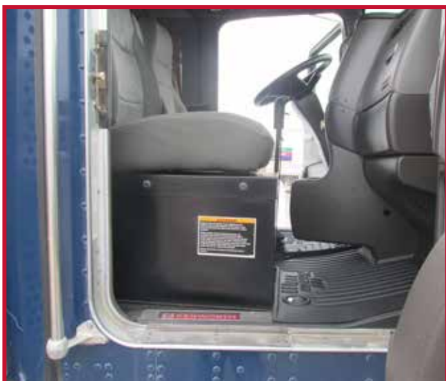
Figura 14 - Caja de la batería del asiento del pasajero con tapete recortado
