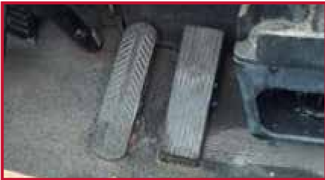
Figure 2 – Pédale d'accélérateur montée au plancher
