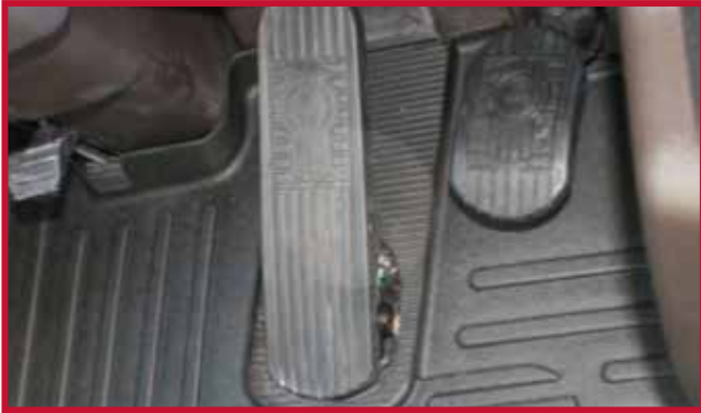
Figure 2 – Pédale d'accélérateur montée au plancher
