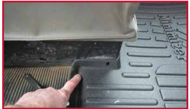
Figure 10 – Emplacement du crochet du tapis côté conducteur
