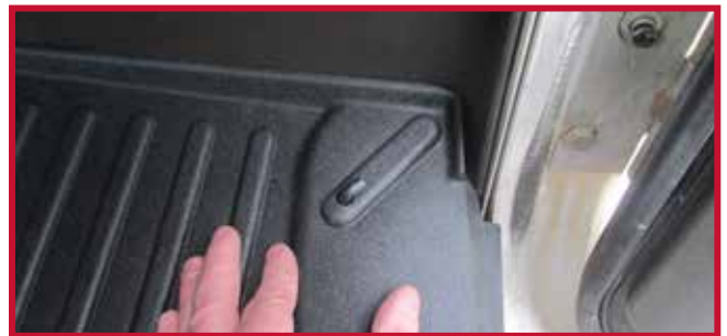
Figure 17 – Crochet de tapis côté passager installé
