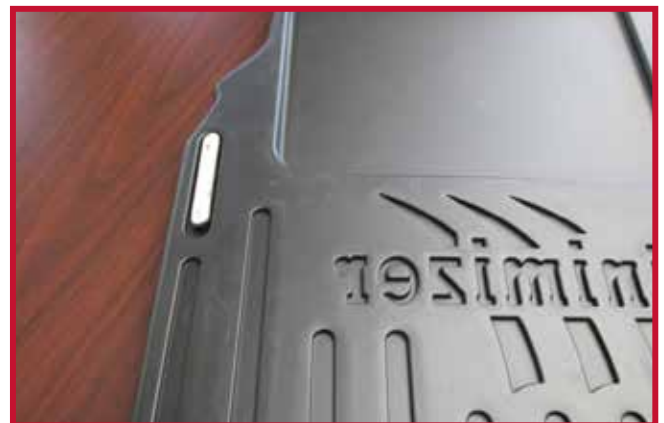
Figura 8 - Gancho y aplicación de Primer 94
