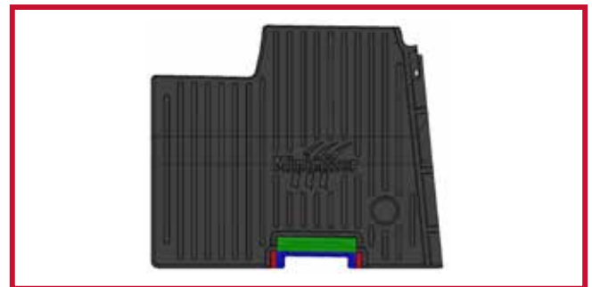
Figura 13 - Diagrama de recorte del tapete del pasajero para los kits 105188, 105190, 105192 y 105194
