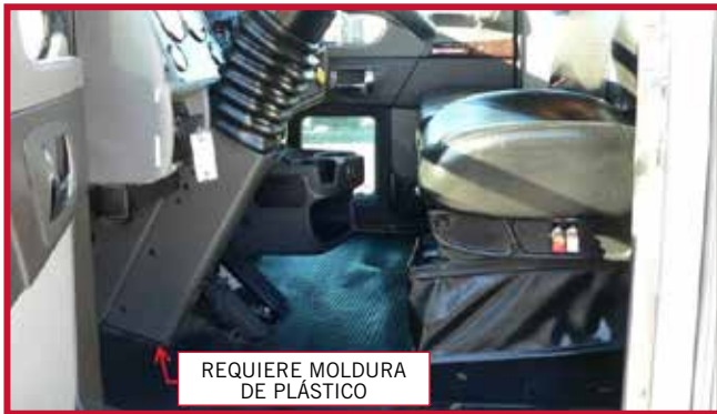
Figura 9 - Montaje de la columna de dirección
