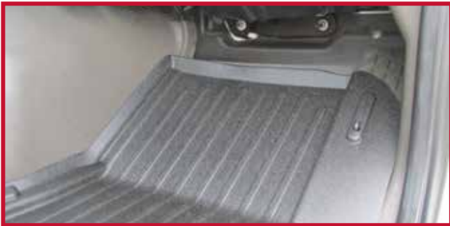
Figura 12 - Tapete y gancho del conductor correctamente instalados
