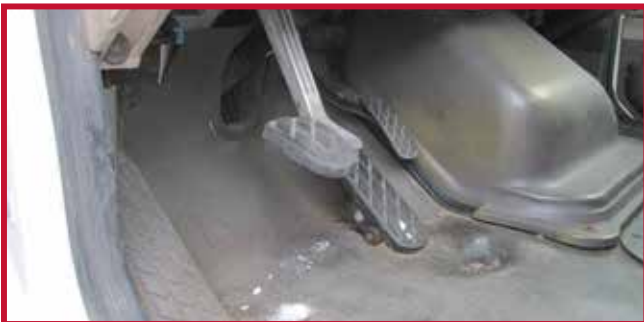
Figura 4 - Pedal de aceleración suspendido con pedal de freno montado en el piso
