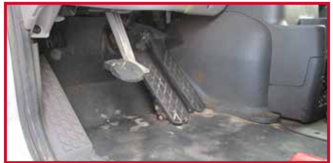
Figura 6 - Pedales de freno y acelerador montados en el piso
