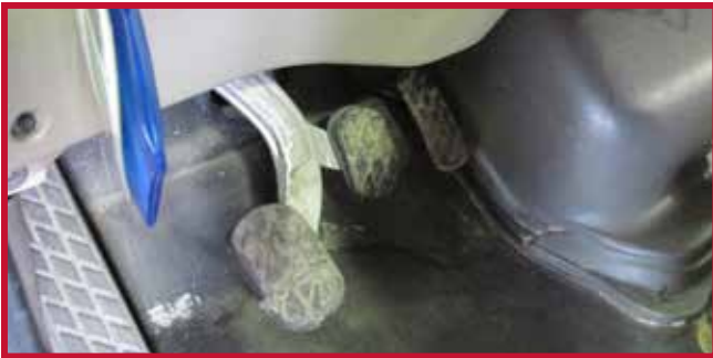
Figura 2 - Pedales de freno y acelerador suspendidos
