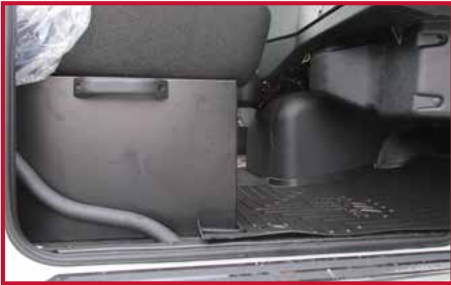
Figure 12 – Siège de passager à base fixe avec tapis découpé
