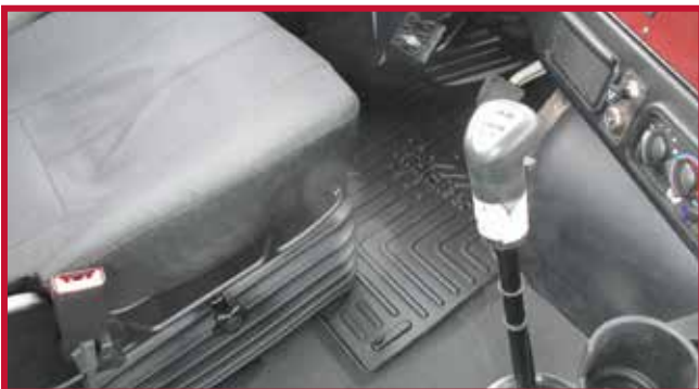
Figure 9 – Crochet du tapis côté conducteur en place
