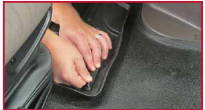
Figure 10 – Appliquer une pression sur le crochet
