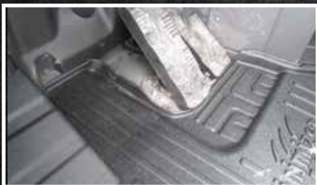
Figura 3 - Contacto del tapete del conductor con el panel de protección.
