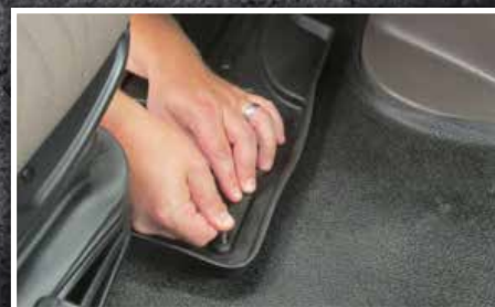
Figure 7 – Appliquer une pression sur le crochet
