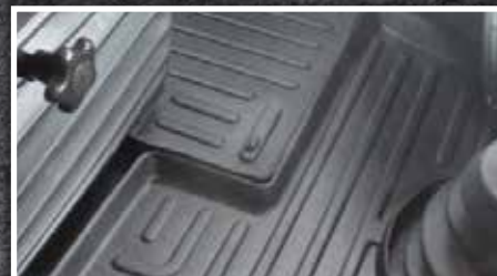
Figura 6 - Confirmar la ubicación del tapete del conductor y el gancho
