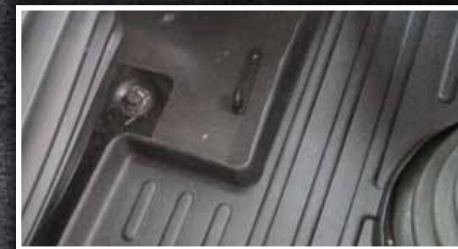
Figura 8 - Gancho de retención correctamente instalado
